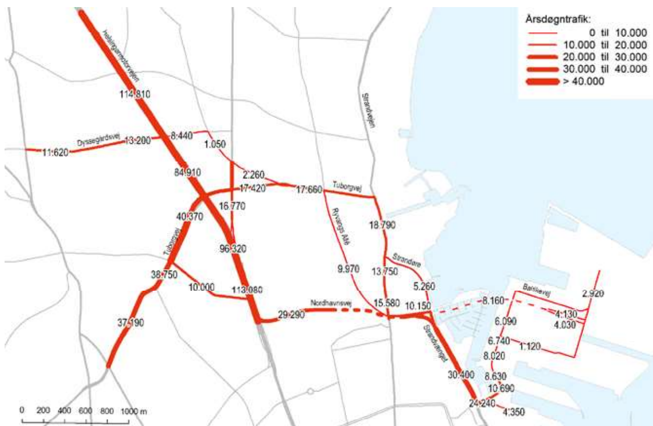
Figur 9.3 Influensvejnet med årsdøgntrafik i 2025, hvor løsning A er anlagt.
