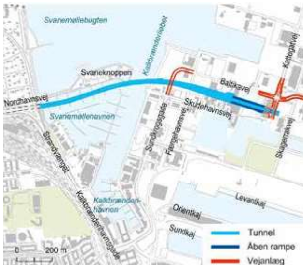
Figur 4.2 Placering af tunnelen i løsning A fra Nordhavnsvej til Kattegatvejs forlængelse på Nordhavn.
