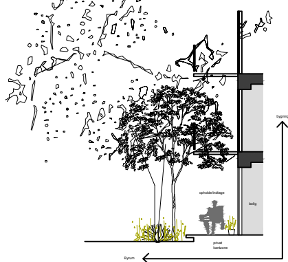
Fig. 11. Principsnit, som viser hævet, bred kantzone ved bolig i stueetagen.
