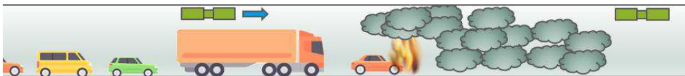
Figur 7-33 Røggashåndtering ved langsgående ventilation – Røgen blæses ud af vejttunnelen i trafikens retning. Personer opstrøms brand er sikret da der her er røgfrit, men zonen nedenstrøms for brand vil være røgfylt og denne zone skal derfor relativt hurtigt tømmes for trafik.
