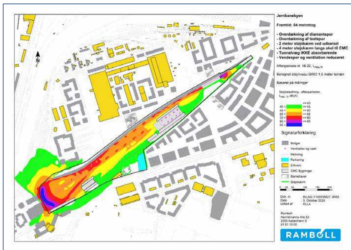
Figur 20-9. Scenarie: Reduceret støj med overdækning. Beregnet støjniveau 1,5 meter over terræn i aftenperioden.
