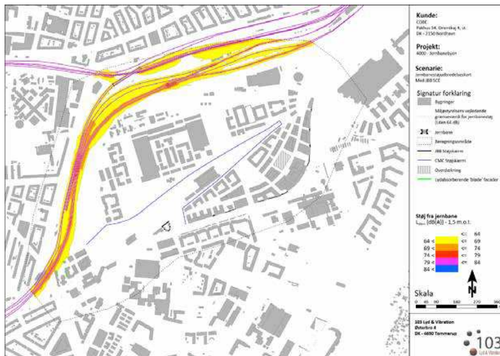
Figur 10-17 Støjdbredelseskort støj L_{den} fra jernbane 1,5 meter over terræn for fremkrevet scenario år 2032 (103).
