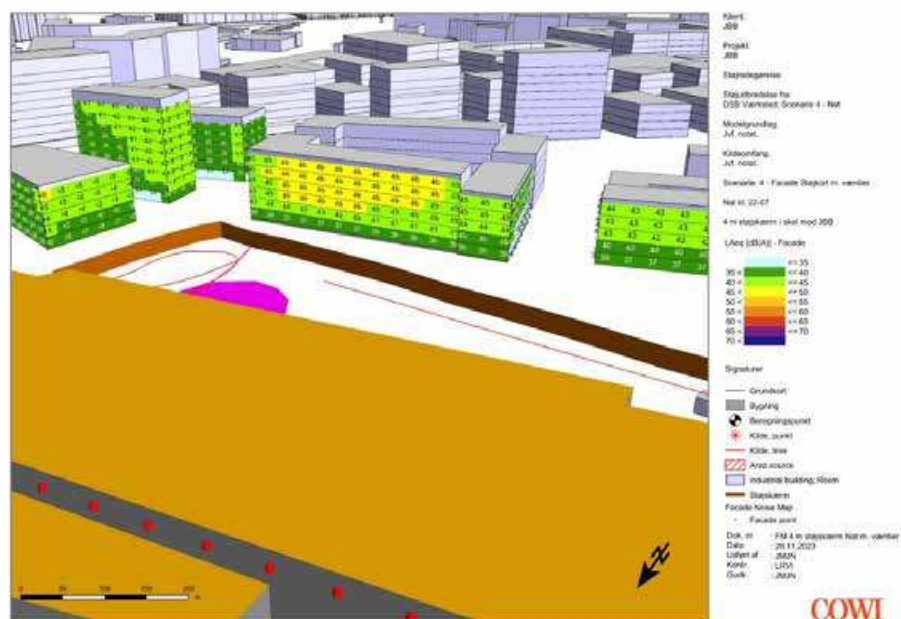
Figur 6-17 DSB Nyt værksted. Facadestøjskort for aftenperioden projektforslaget (år 2024) af nyt værksted i natperioden med 4 meter høj støjskærm i skel (COWI).
