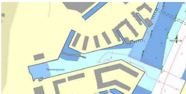
Figur 2-2 Søkort fra Eniro, som viser vanddybden i Tømmergraven
