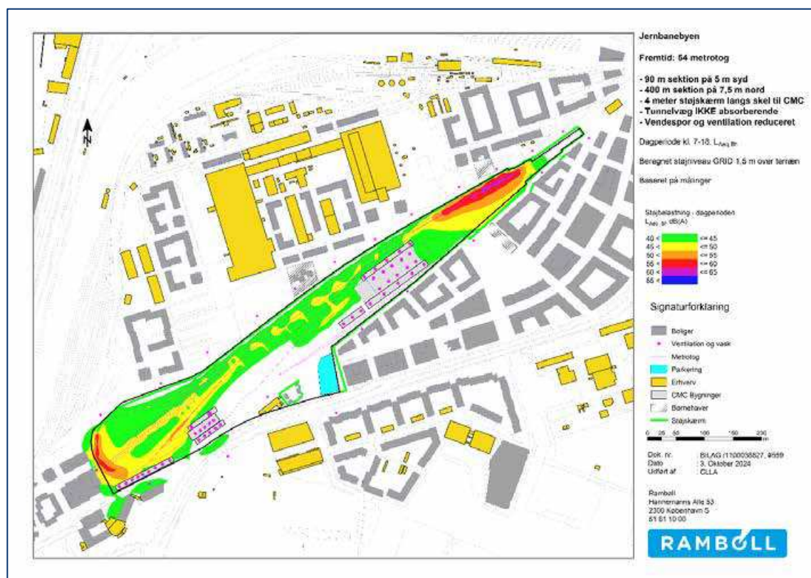
Figur 20-13. Scenarie: Reduceret støj uden overdækning. Beregnet støjniveau 1,5 meter over terrænet i dagperioden.
