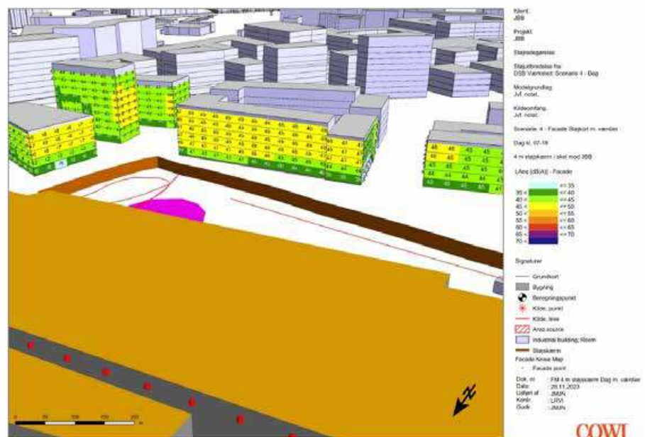
Figur 6-15 DSB Nyt værksted. Støjdbredelseskort for projektforslaget (år 2024) af nyt værksted i natperioden, 1,5 meter over terræn svarende til friarealer og stueetage med 4 meter høj støjskærm i skel (COWI).
