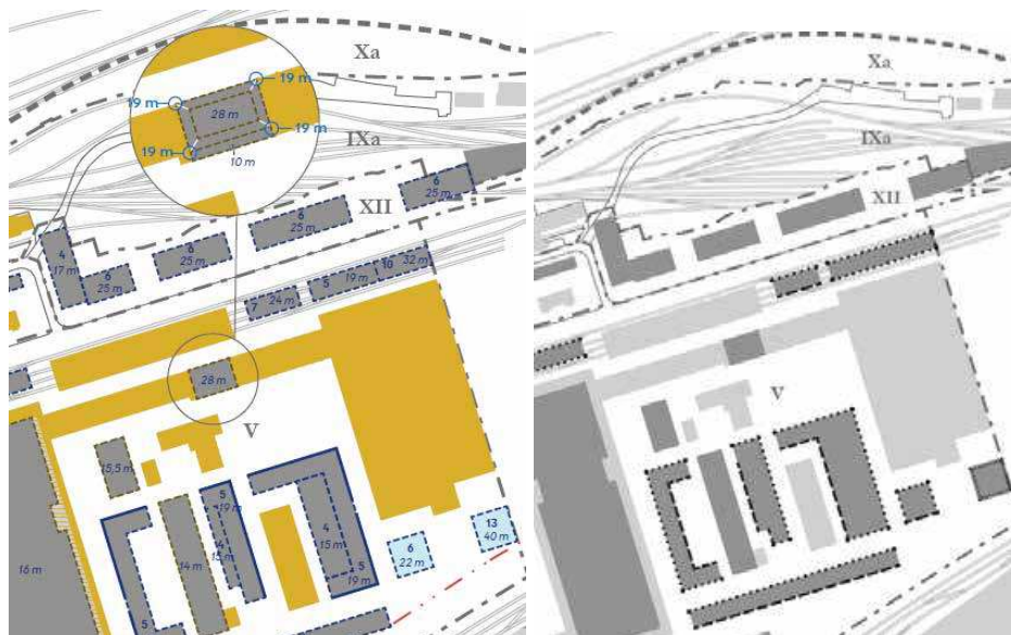
Figur 5-46 Tv. udsnit af tegning 5b3 · Bebyggelsens omfang og placering · IV, V, VII, XII, som viser hvilke muligheder, der er for påbygning på Kølerværkstedet. Th. udsnit af tegning 6c3 · Altaner · IV, V, VII, Københavns Kommune, 2026.
