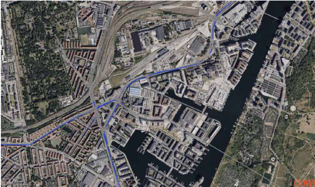
Figur 5-6 Kortet viser den beregnede gennemsnitlige kølængde i Basis 2035 i hele netværket (kl. 7:00-9:00). Det bemærkes, at der i beregning af køen fra vest frem mod Sydhavns Plads ikke er medtaget kryds længere mod vest end Enghavevej, hvorved køen alene beregnes fra Enghavevej og ikke med den opdeling af køen, som ellers vil forekomme i virkeligheden. Tilsvarende princip gælder for de øvrige veje frem mod beregningsvejnettet.
