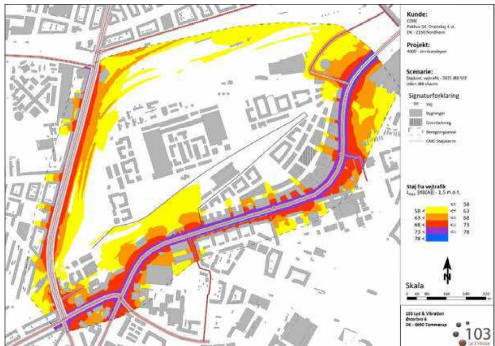
Figur 5-1 Støj jdbredelseskort vejtrafikstøj 1,5 meter over terrænen for fremtidigt scenario med udbygning af Jernbanebyen år 2035 (103) uden støjskærme mod Vasbygade og Enghavevej
