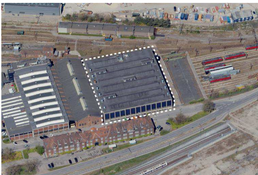
Figur 5-117 Ny eftersynshal ses i midten af billedet og er markeret med en stiplede linje. Illustration COWI.
