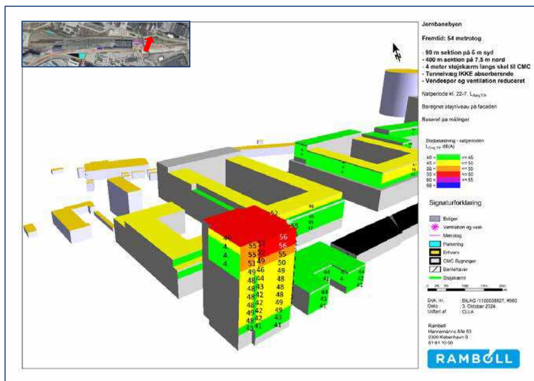
Figur 20-23. Scenarie: Reduceret støj uden overdækning. 3D opstalt af beregnet støjniveau på facaden i natperioden. Grå facader er udsat for støj med niveauer under 40 dB. Bygninger nordøst for CMC.
