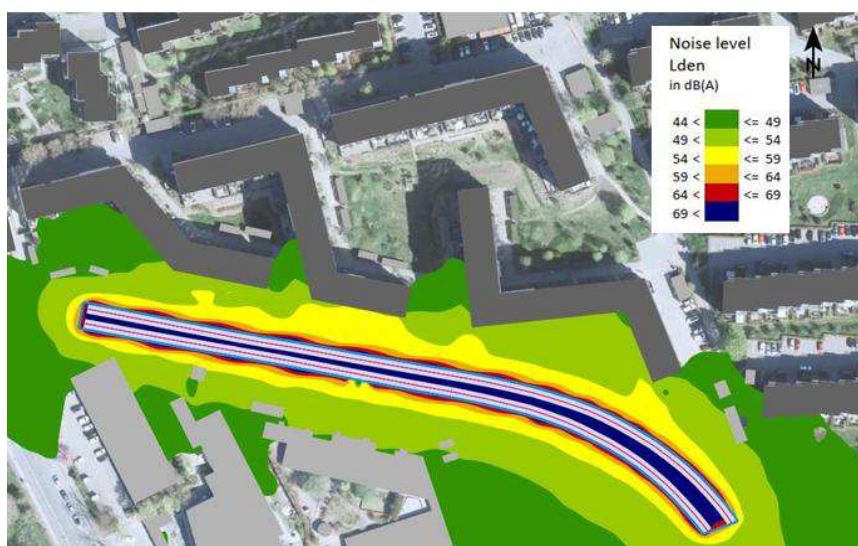
Figur 5: Støjniveaukurver 1,5 meter over terræn (nuværende layout)
