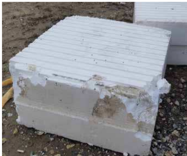
Flamingopladerne bruges til isolering af f.eks. fundament- og ligger i stakkevis på byggepladserne.
