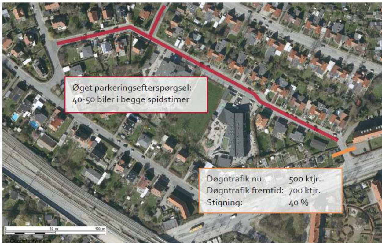
Figur 21: Forventede trafikale konsekvenser ved etablering af en ny institution på Saxtorphsvej såfremt der ikke iværksættes afværgeforanstaltninger.
