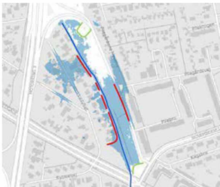
Figur 3-8 Områder der ligger lavere end kote 12,0 m DVR90. Røde streger angiver strækninger, der skal terrænreguleres. Grønne streger angiver strækninger, hvor bygninger mm. der ligger lavere end kote 12,0 m DVR90 skal sikres mod oversvømmelse.
