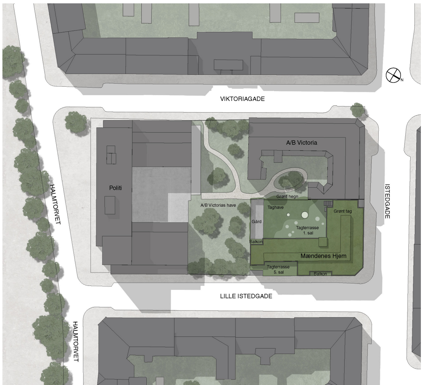
Visualisering af situations- og tagplan efter påbygning af 2 etager med grønt tag og udbygning af stueetagen i gårdrummet med anlæg af byrum på taget. Illustration: Albjerg & Buchardt.
