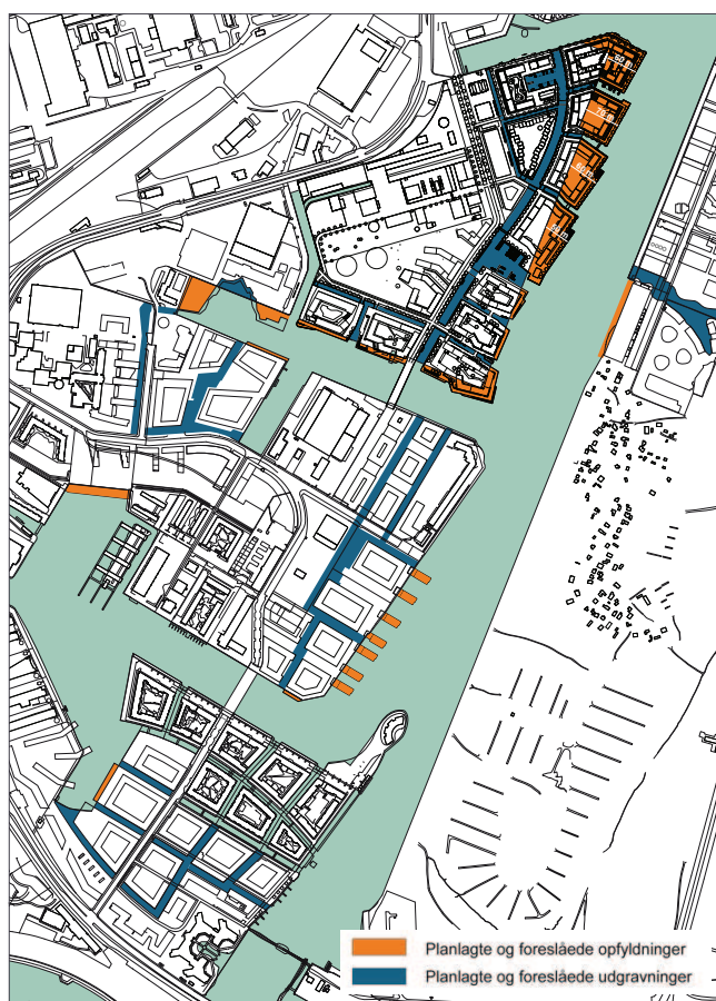
Opfyld og udgravning i Sydhavnen. På Enghave Brygge afgraves ca. 30.000 m 2 og opfyldes ca. 35.000 m 2 . Bebyggelsesplanen er ikke opdateret.
