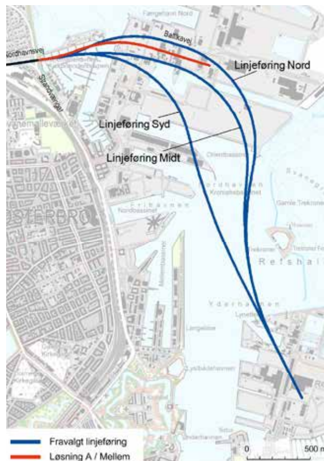
Figur 12.2 Fravalgte mulige placeringer af vejttunnelen i Svanemøllehavnen og Kalkbrænderihavnen og en eventuel videreføring i en Østlig Ringvej.
