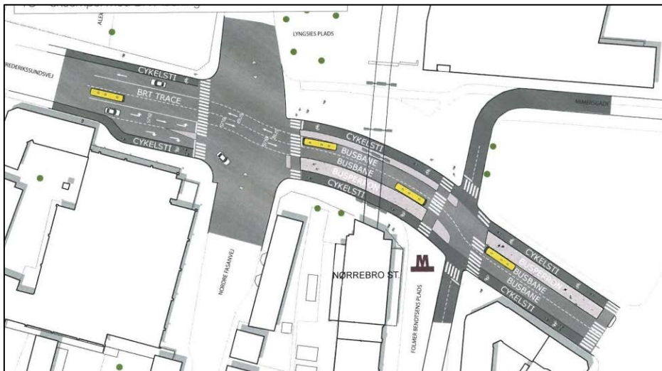
Nørrebro Station, eksempel med en højklasset busløsning. I udadgående retning stopper busserne ved Basargrunden inden højbanen.
