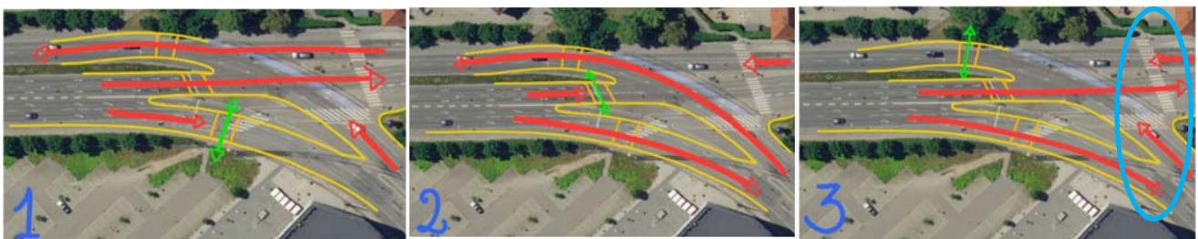
Figur 3. Overordnede signalfaser i krydset Scandiagade/Sydhavns-gade med ekstra overgang.
