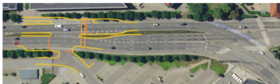
Figur 4. Signalregulering af krydset ved A.C Meyers Vænge. Principskitse. Udformningen kan ikke anbefales
