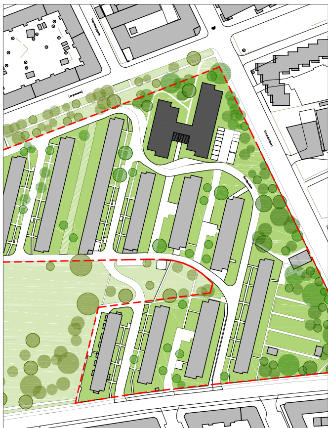
Situationsplan. Plejecentret ønskes placeret tilbagetrukket med grønt omkring bygningen. Placering og indretning af adgang, parkering og haverum er principiel og skal afklares nærmere i det videre forløb. Illustration af Sangberg.
