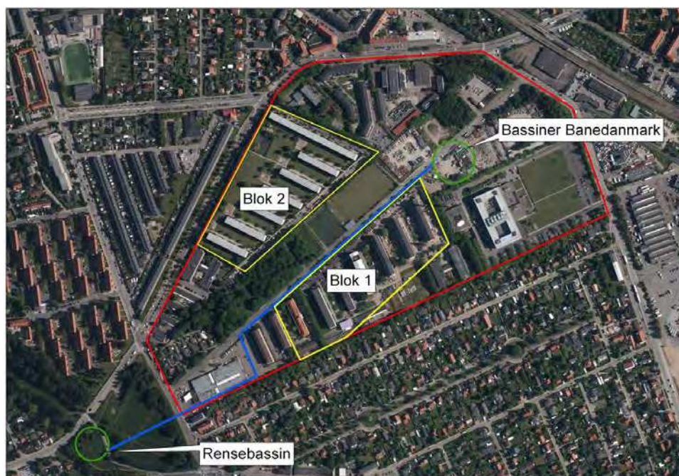
Trace for regnvandsledning og frakobling af blokke
