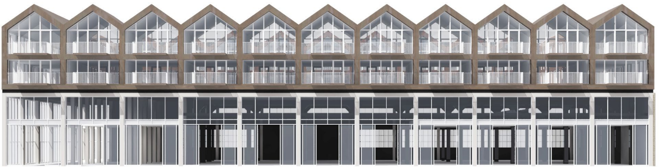
På Basecamp bygges en ny boligbebyggelse ovenpå den eksisterende industrielle hal. Den eksisterende hal står med rammer af beton, mørkpuksede facader og vinduer med industriel karakter. Illustration: Gjode & Partnere.
