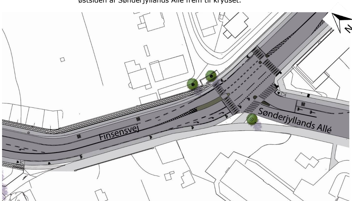
Figur 26: Illustrationsplan af krydset Finsensvej / Sønderjyllands Allé (se endvidere tegning 2G26-7)
