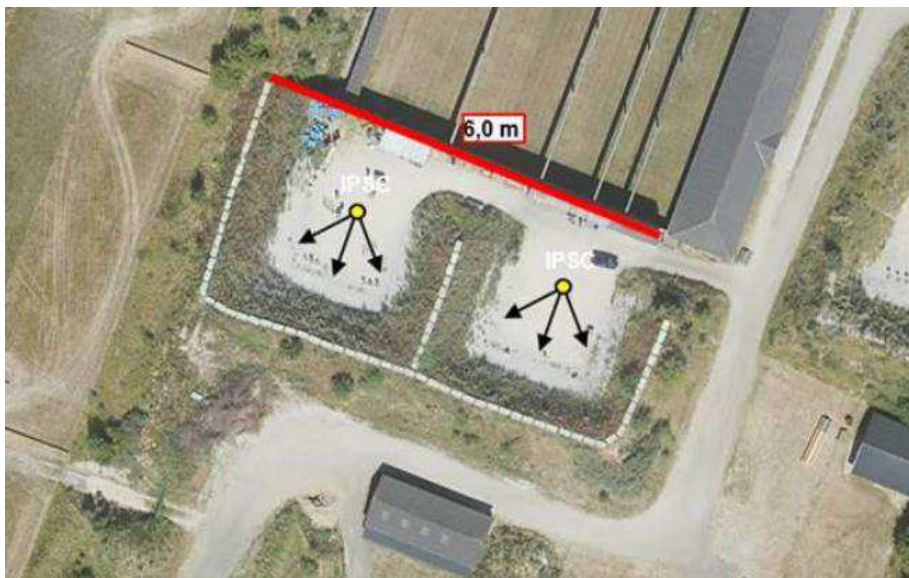
Figur 13-3 - Støjdæpende foranstaltning Bane 14-15, /XX/
