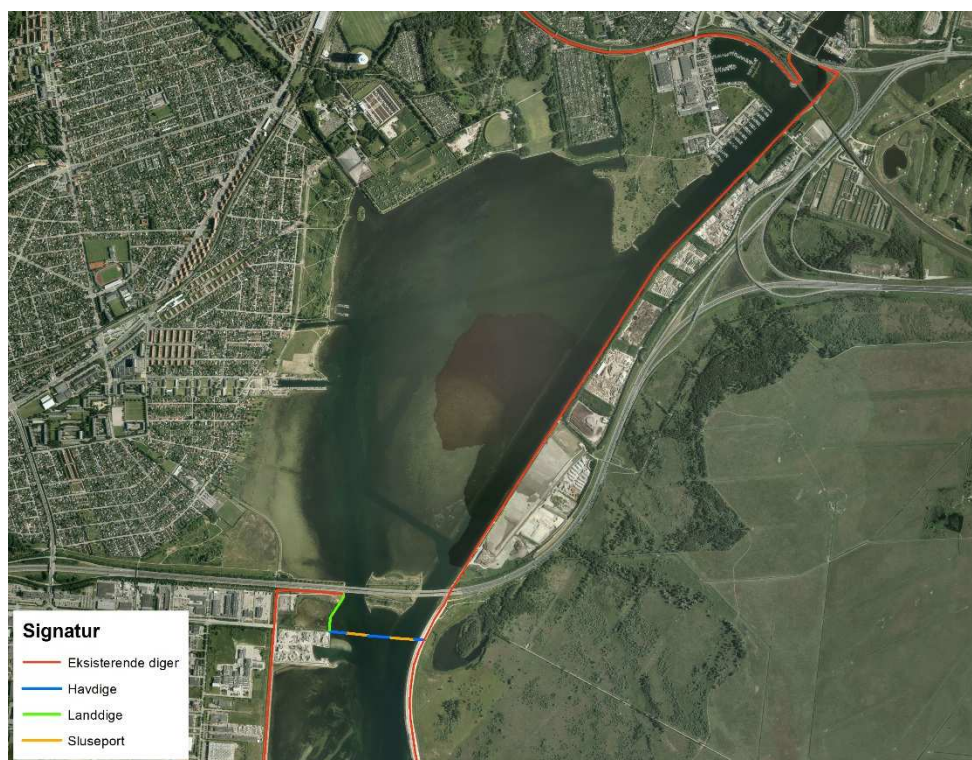
Figur 12: Forslag til stormflodssikring af Kalveboderne.
