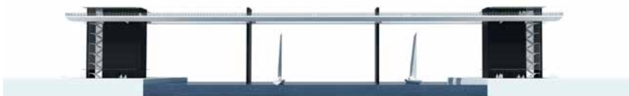
Figur 2.7 Højbroen vil være 205 meter lang og ca. 22 meter høj med elevatorskakte i hver ende.
