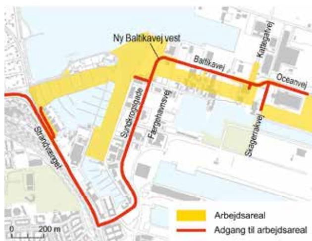
Figur 8.2 En del af Svanemøllehavnen, Kalkbrænderiløbet, Svaneknoppen og området omkring Baltikavej, Kattegatvej og Oceanvej vil blive inddraget til arbejdsareal. Der vil være adgang til arbejdsarealerne fra Strandvænget, Sundkrogsgade og Baltikavej.
