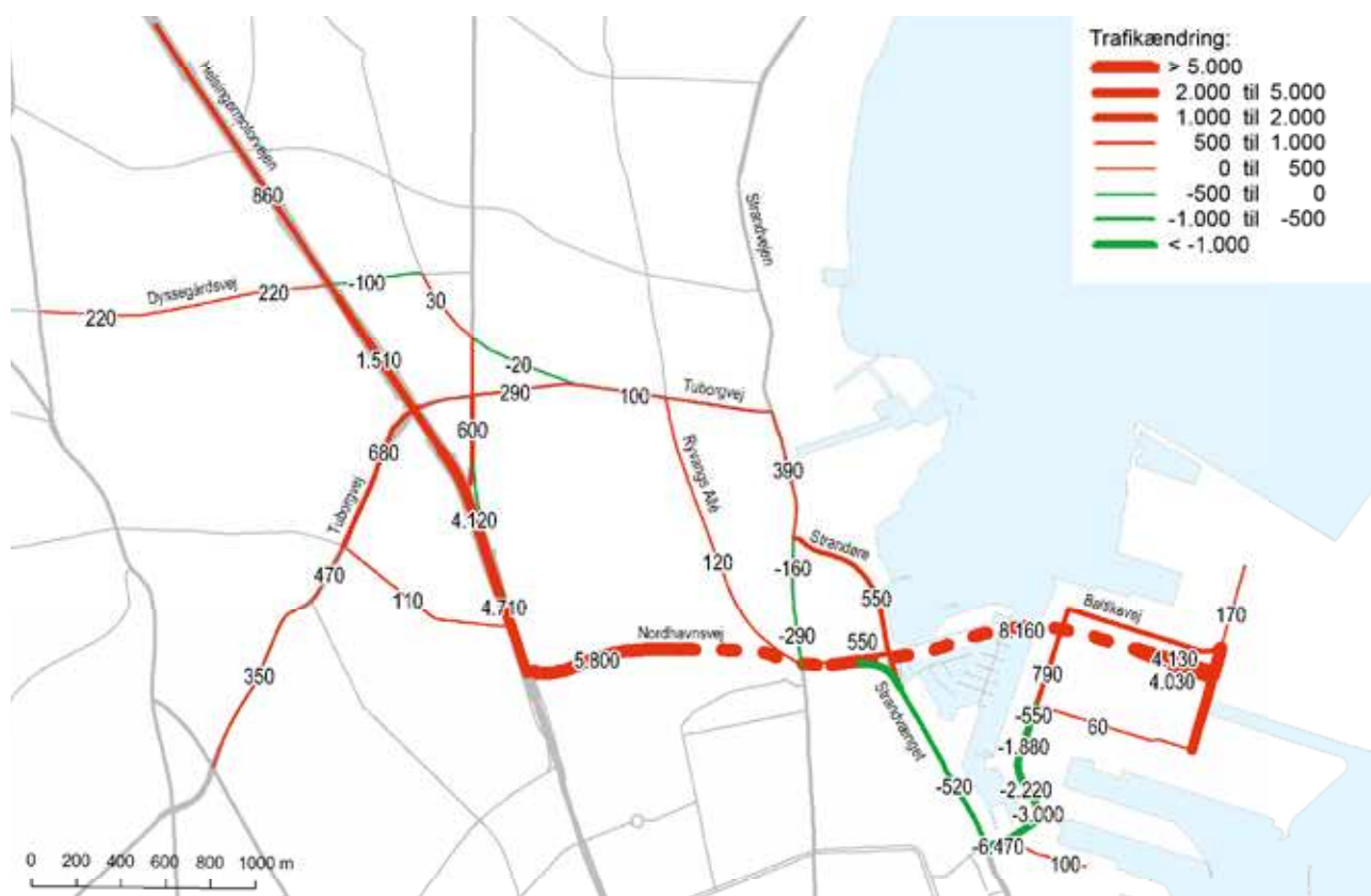
Figur 9.4 Influensvejnet med årsdøgntrafik med den trafikændring, der udgør forskellen mellem 0-alternativet i 2025 og løsning A i 2025.
