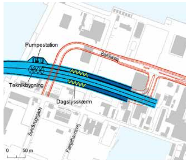
Figur 4.11 Tunnelportal øst for Færgehavnsvej, hvor billisterne kommer til og fra tunnelen via ramper på hver side af tunnelen.
