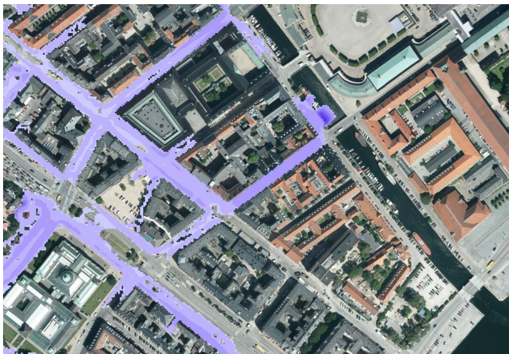
Figur 7 Simuleret oversvømmet areal ved en 100-års regnhændelse i 2010
