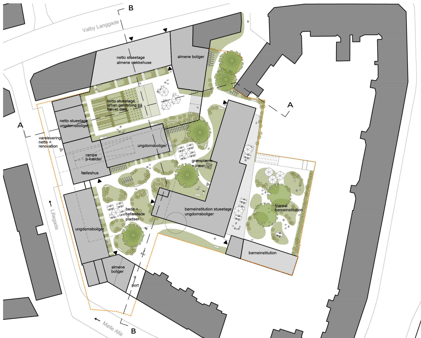
Situationsplan med markering af stiforbindelse der viser et eksempel på et nybyggeri i overensstemmelse med lokalplanen. Illustration: Entasis.
