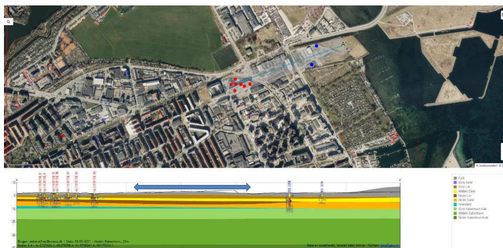
Figur 7-16: V-Ø gående profil gennem områdets borer. Centerlinje af lokalplanområdet ved blå pil, ca. 200-400 m på profilet fra GeoAtlas Live. Som baggrund for borerne vises den såkaldte København model i 25 m's opløsning.
