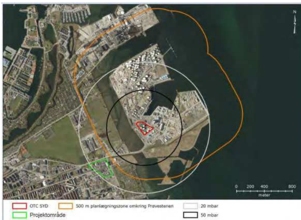
Figur 7-13: Illustration af udbredelsen af trykpåvirkningslinjerne for hhv. 50 mbar og 20 mbar, samt en markering af 500 m planlægningszone omkring Prøvestenen. Projektområdet er markeret med grønt. Kilde: Rambøll /8/.
