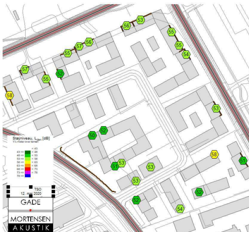
Figur 7-6. Støjniveauer på tagterrasser med 1,8 m høje støjskærme.
