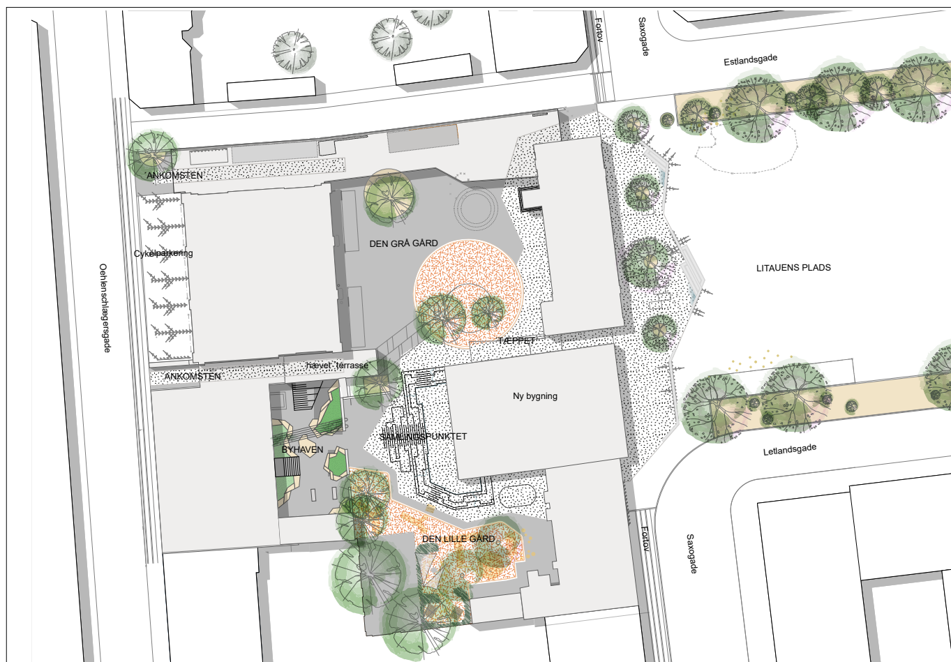
Situationsplan, mulig udformning af ny bygning og udearealer i sammenhæng med den eksisterende bebyggelse. Ill.: TRUST
