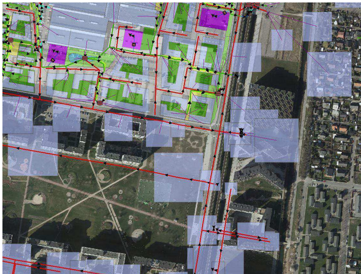
Figur 15 udsnit af model ved Bella med angivelse af arealer koblet til kloaksystemet. De kvadratiske arealer ikke en tilsvarende placering på udbredelsen, da de er udarbejdet på et tidligere tidspunkt med et andet grundlag.
