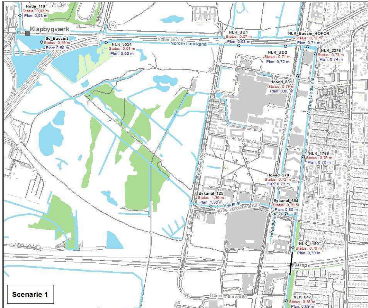
Figur 9 Oversigtskort med angivelse af maksimal vandspejlskote i Nordre Landkanal (fra E20 til udløb i havnen) for statussituationen (nuværende forhold) og plansituationen (når Bellakvarter er udbygget) for en 5-års regn med sikkerhedsfaktor 1,38. Koten for status er angivet med rødt og plan med blåt . Resultaterne er udført for scenarie 1, hvor vandstand i havn og Nordre Landkanal er i kote 0,0 m.
