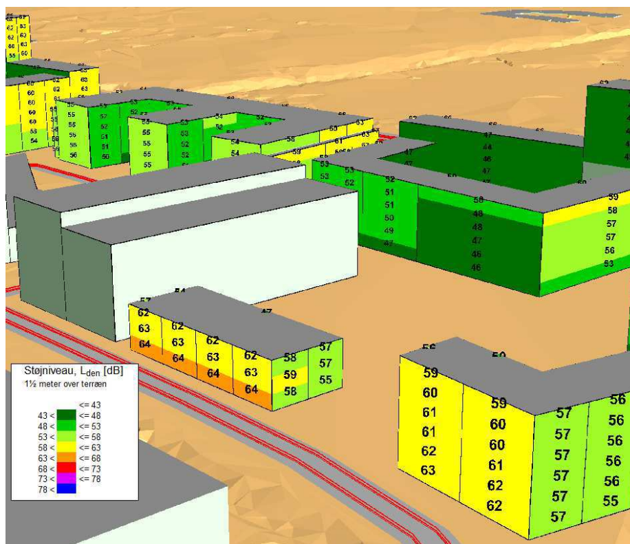
Figur 8: Vejtrafikstøj i frit felt på boligernes facader angivet som L_{den} i dB
