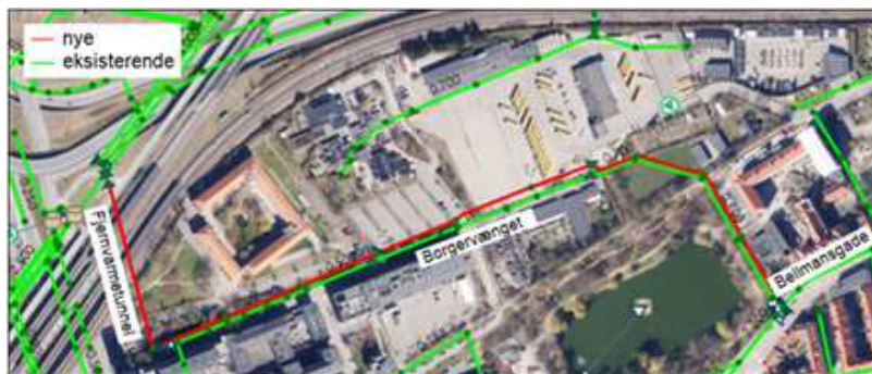
Figur 1: Ny ledning fra reguleringsbygværk i Bellmansgade via Borgervænget og den tidligere fjernvarmetunnel til Svanemøllen Skybrudstunnel.
