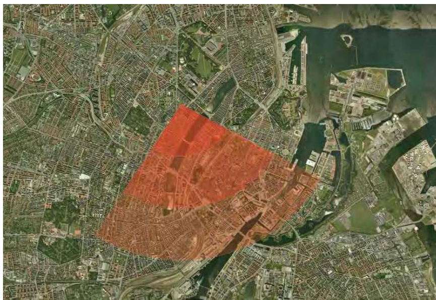
Fig. 7.1.8: Den visuelle påvirkning mod sydvest og sydøst. Påvirkningen er kun tydelig i den inderste zone.. De 3 zoner har hver en bredde af 1 km. Se bilag 13 for en større udgave af figuren.
