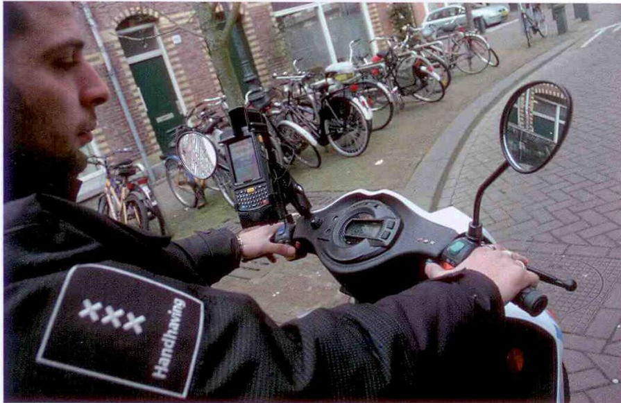
Figur 4: P-vagt på Scanscooter med integreret håndterminal
