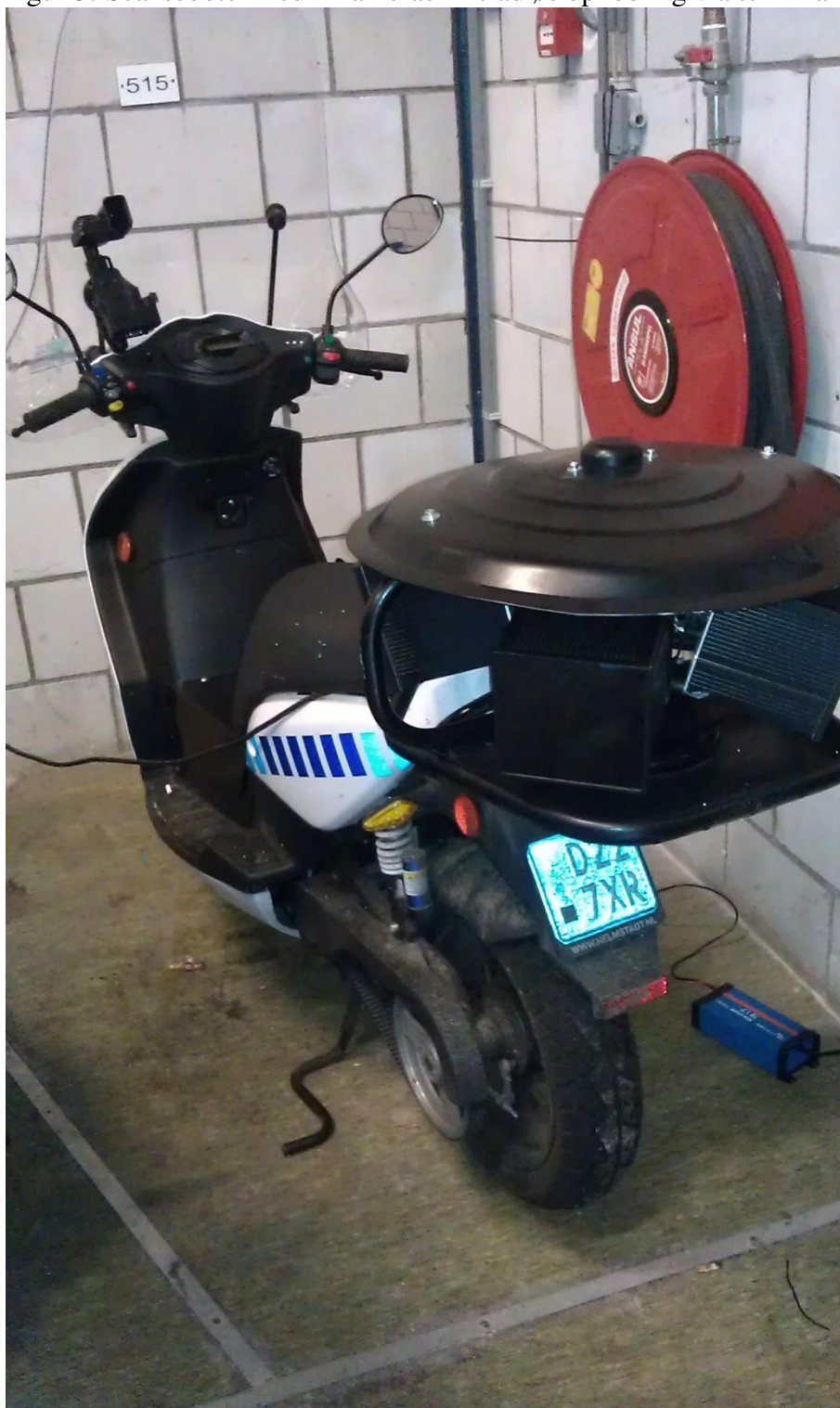
Figur 3: Scanscooter med 2 kameraer + trådløs opkobling via terminal
