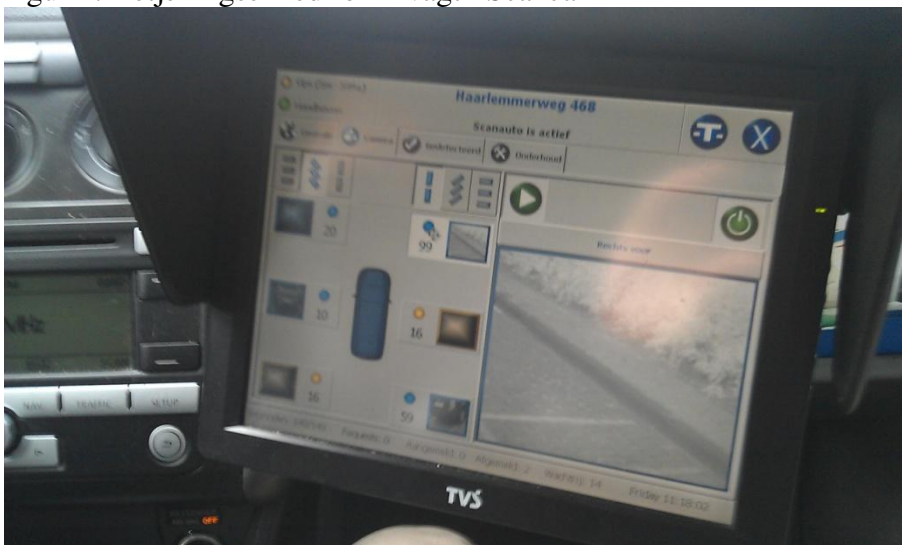
Figur 2: Betjeningsenhed for P-vagt i Scancar
