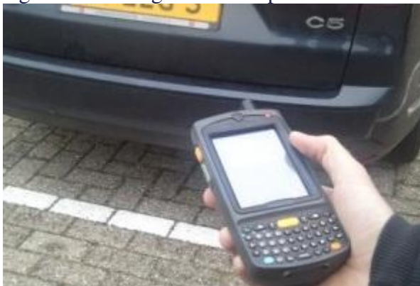
Figur 6: Scanning af nummerplade med håndterminal
