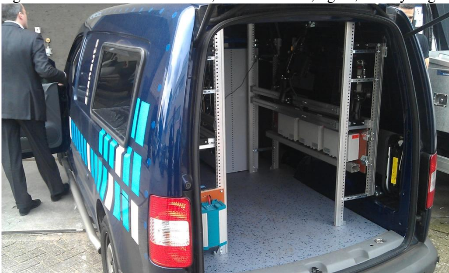
Figur 1: Scancar med 6 kameraer, IT-installation, og strømforsyning
