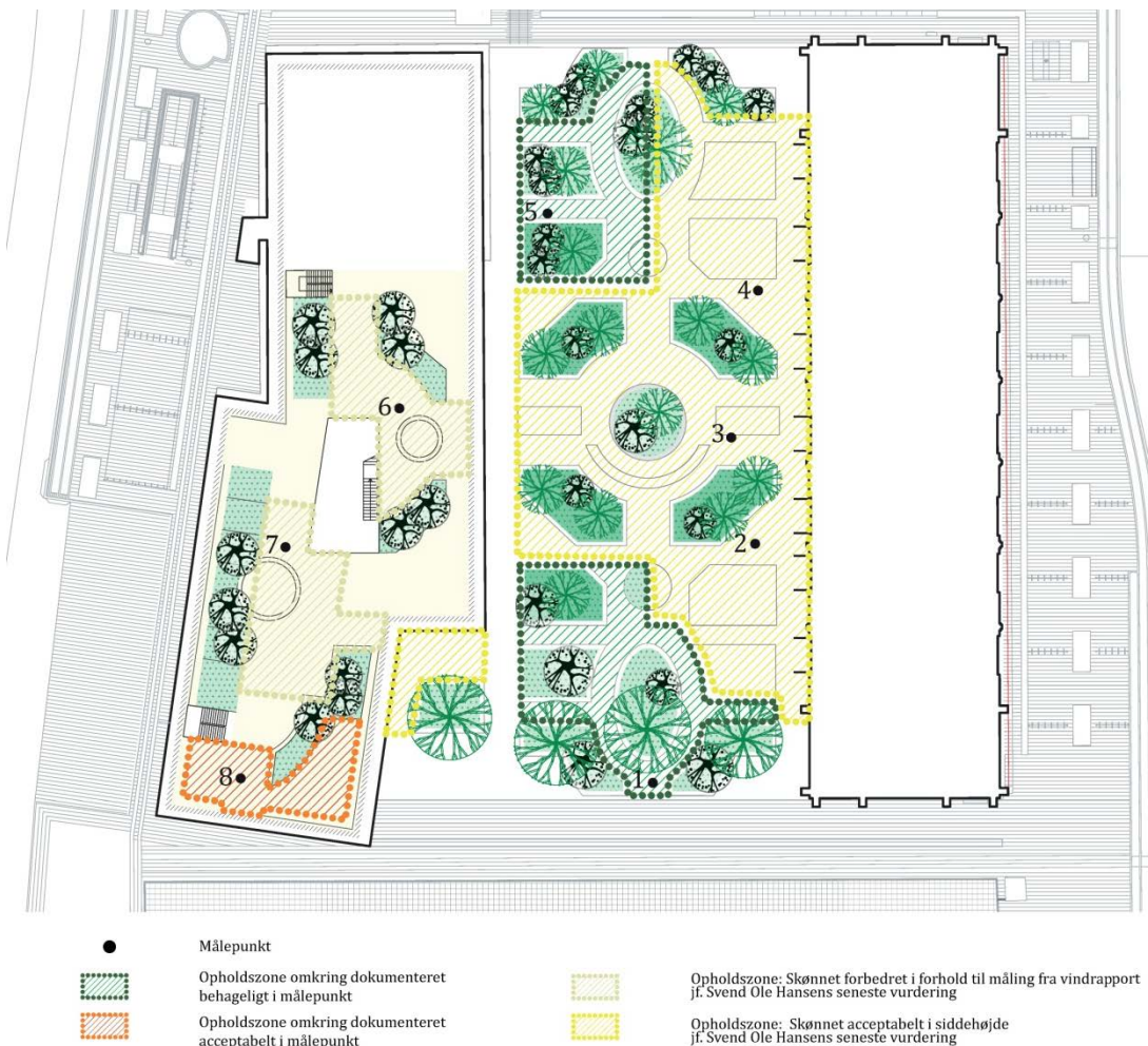
Illustration 1: Principtegning for beplantningsscenario, som er vurderet i forhold til vind. De grønne felter viser områder med behageligt vindmiljø, de gule og orange felter viser vurderet eller målt acceptabelt vindmiljø, og de lyse felter på tagterrassen viser områder, hvor beplantningen forbedrer vindmiljøet i forhold til analyserne, men hvor der ikke er dokumenteret acceptabelt vindmiljø. Illustration: Arkitekt Kristine Jensens Tegnestue.
