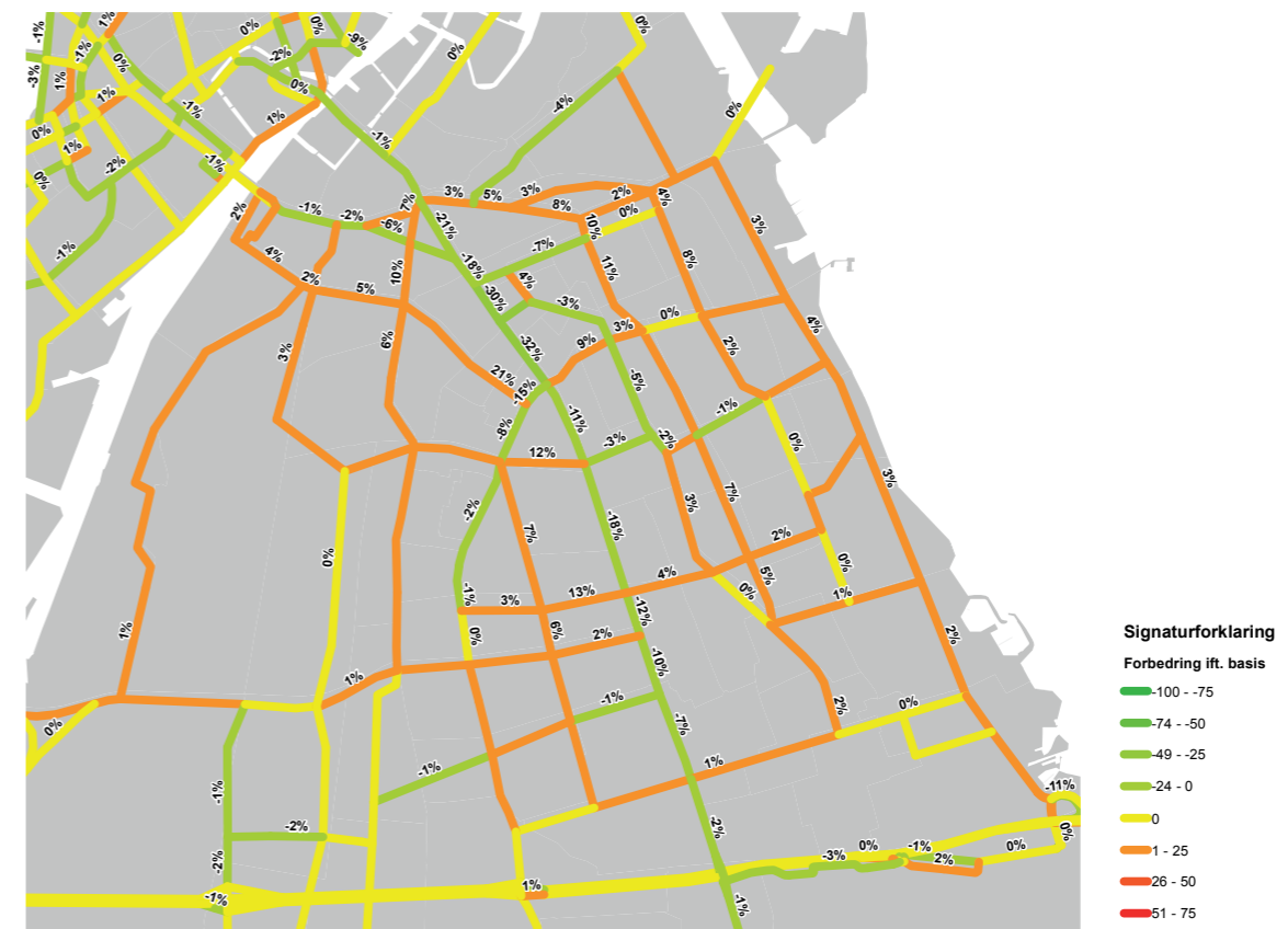
Ændringer i biltrafik på døgnniveau opgjort i procent, som følge af helhedsplanen Grøn = færre biler Rød = flere biler
