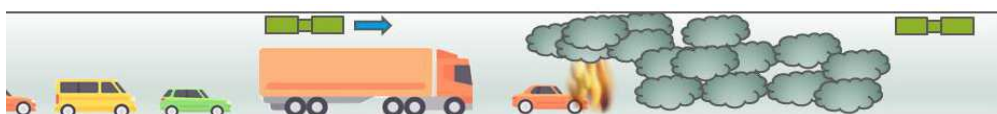
Figur 7-33 Røggashåndtering ved langsgående ventilation – Røgen blæses ud af vejttunnelen i trafikens retning. Personer opstrøms brand er sikret da der her er røgfrit, men zonen nedenstrøms for brand vil være røgfylt og denne zone skal derfor relativt hurtigt tømmes for trafik.
