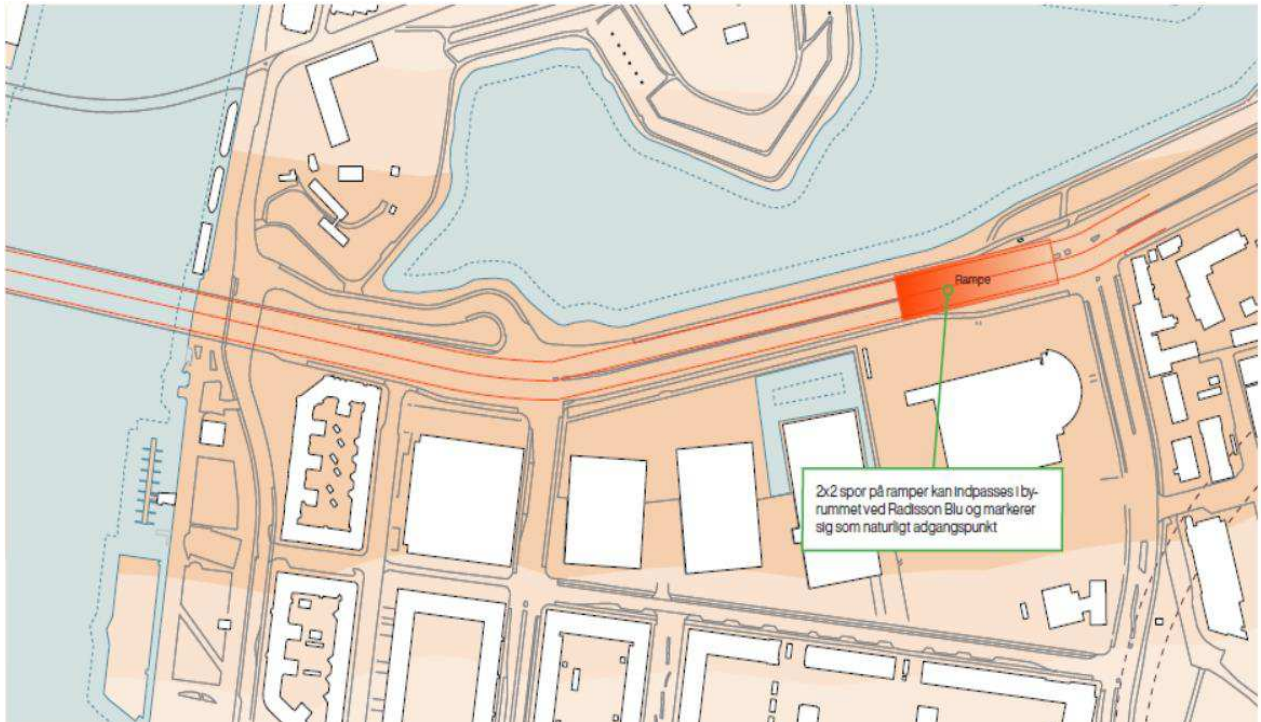
Figur 5-28 Hovedrampe ved Amager Boulevard vurderes mulig at indpasse, og kan have positiv indvirkning på byrummet karakter. Rampe vil markere sig som portal for den samlede tunnel.
