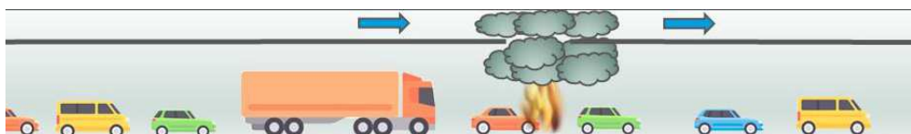
Figur 7-34 Røggashåndtering ved udsugning (semi-transvers ventilation) – Røgen suges væk fra vejttunnelen og op i en kanal. Personer på begge sider af brand vil være i sikkerhed.
