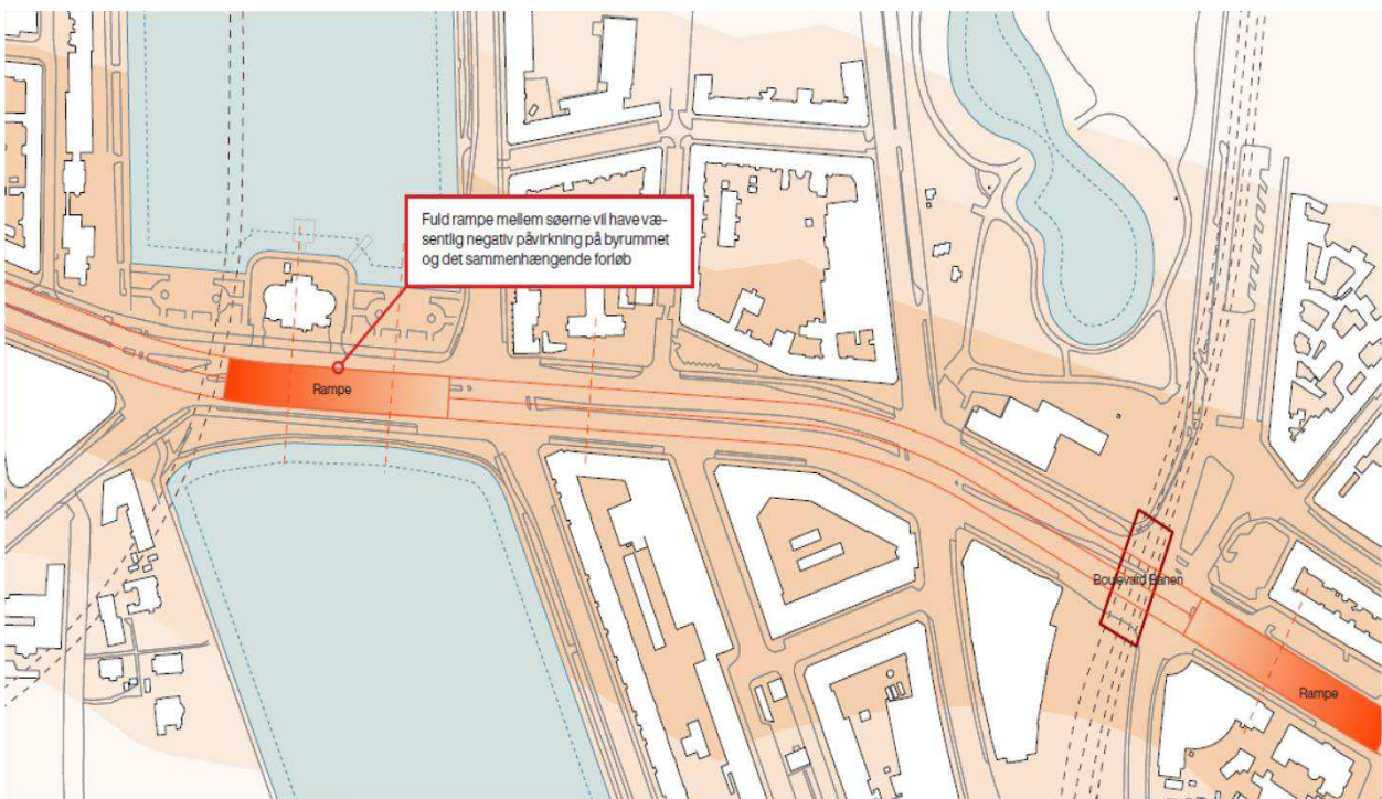
Figur 5-11 Hovedrampe mellem søerne vil betyde en væsentlig barriere i byrummet. Anlægget skal bearbejdes som bygværk og tænkes i dobbeltprogrammer, for at skabe merværdi i udformningen.
