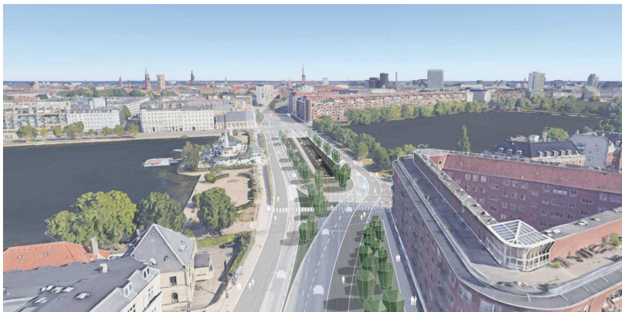
Figur 5-22 Princip for rampe ved Sørerne
