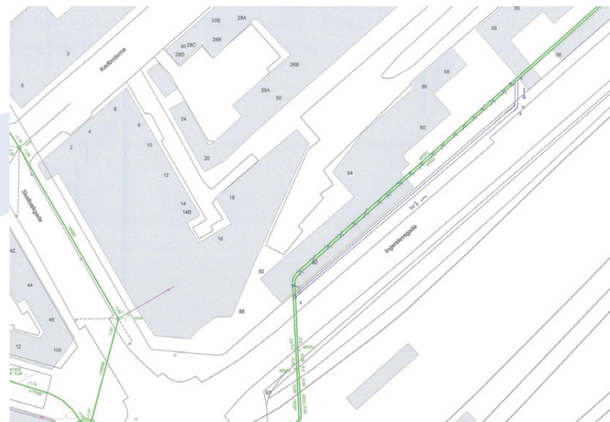
Figur 3; Omlægning af afløbstrykledning
