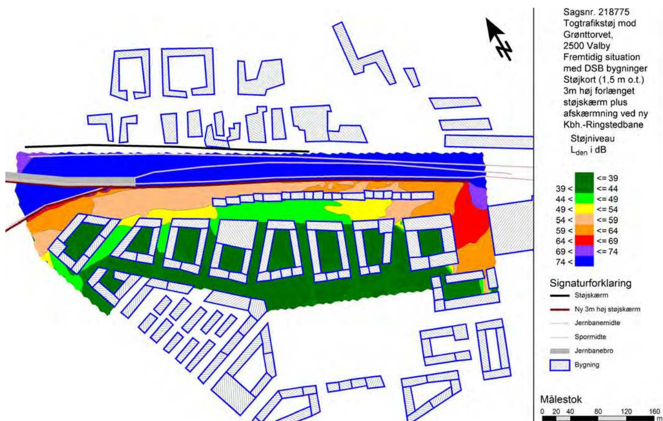
Beregning af fremtidig togtrafikstøj med bebyggelse på DSBs areal og 3 m høje støjskærme. Niras
