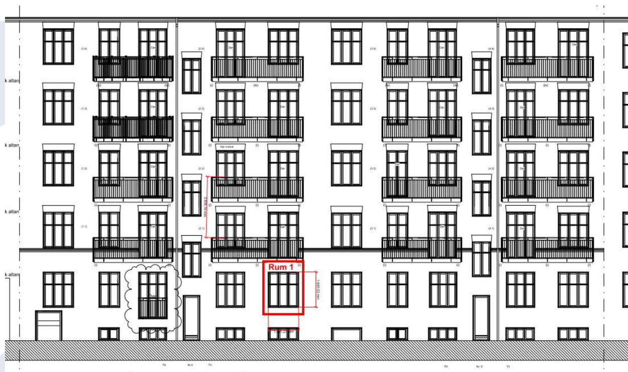
Figur 2 – Facadetegninger med udvalgte kritiske rum markeret
