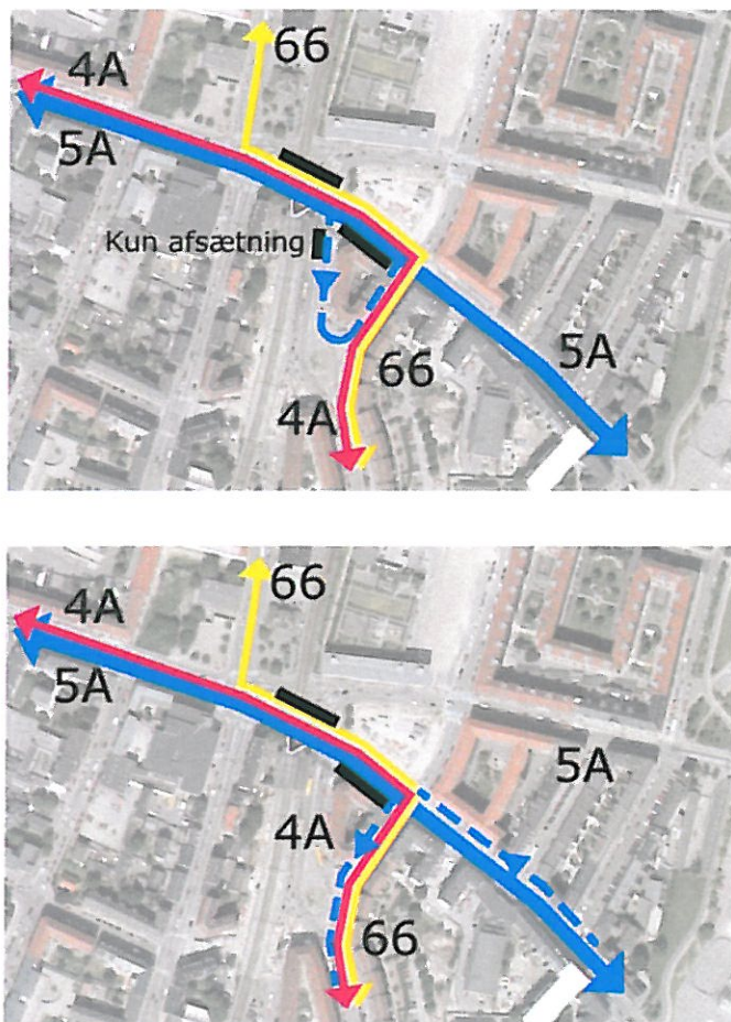
Figur 2. Oversigt over de undersøgte løsninger. Øverst løsning 1B, nederst løsning 3B
