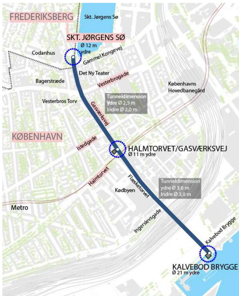
Figur 2.1: Oversigt over placering af skybrudstunnel og bygværkerne ved Skt. Jørgens Sø, Halmtorvet/Gasværksvej og Kalvebod Brygge.
