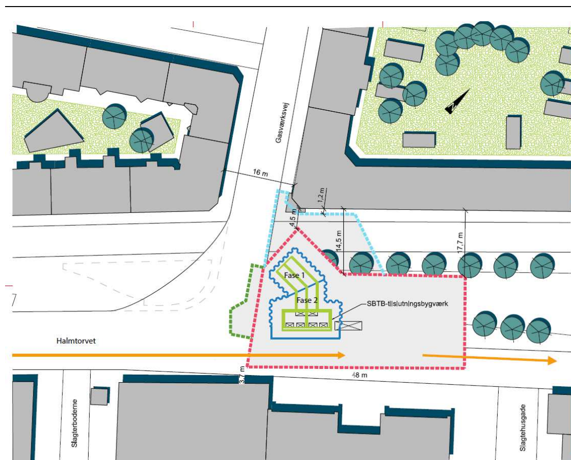
Figur 8.6: Afgrænsning af byggeplads Halmtorvet/Gasværksvej for kommende byggeskakt, fase 1 (etablering af tilslutningsbygværk) Rød linje angiver den overordnede byggepladsafgrænsning i perioden; den grønne stiplede linje en 3 ugers udvidelse; og den blå stiplede linje en 4 ugers udvidelse. . Grøn linje er tilslutningsbygværket, der ligger under jorden og blå er de spursen rundt om. Potentiel til- og frakørselsvej via Sønder Boulevard for byggeplads trafik vist med fuldt optrukne orange linjer. Midterhellen i Halmtortorvet vest for byggepladsen indskrænkes, så der fortsat er plads til adskillelse af cyklister og fodgængere fra biltrafikken. Nuværende anlæg er vist med stiplet signatur.
