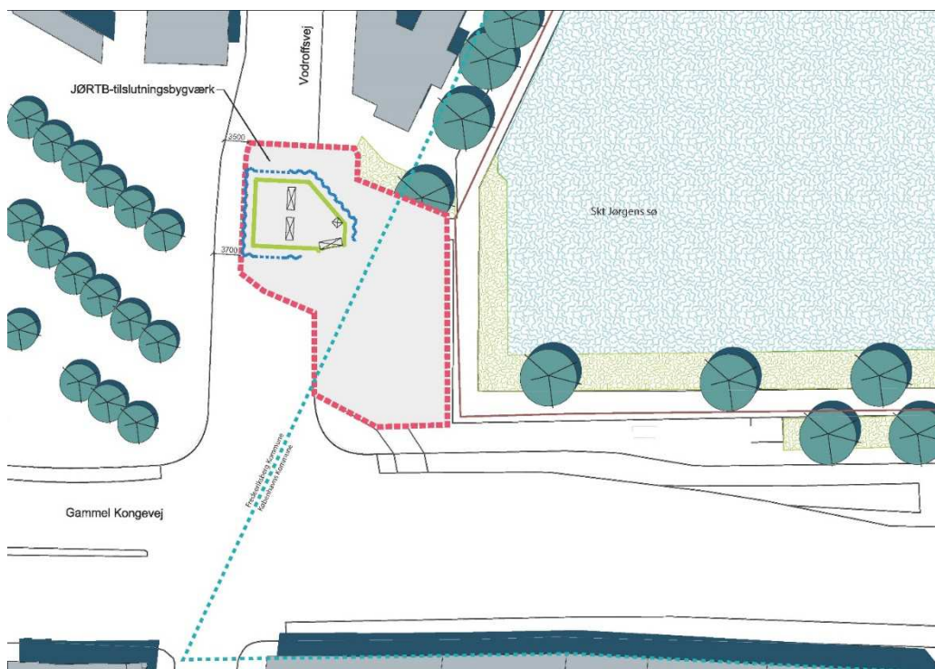
Figur 2.2: Byggepladsen ved Skt. Jørgens Sø i anlægsfase 1, hvor tilslutningsbygværket etableres
