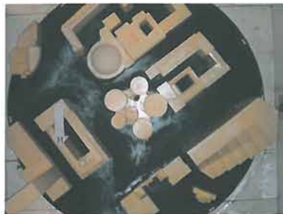
Figur 5.2. Visualiseringsforsøg med høj vind fra nord.
