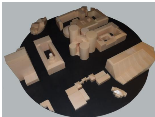
Figur 1.1. Vindtunnelmodel af Axeltorv samt nabobebyggelse.
