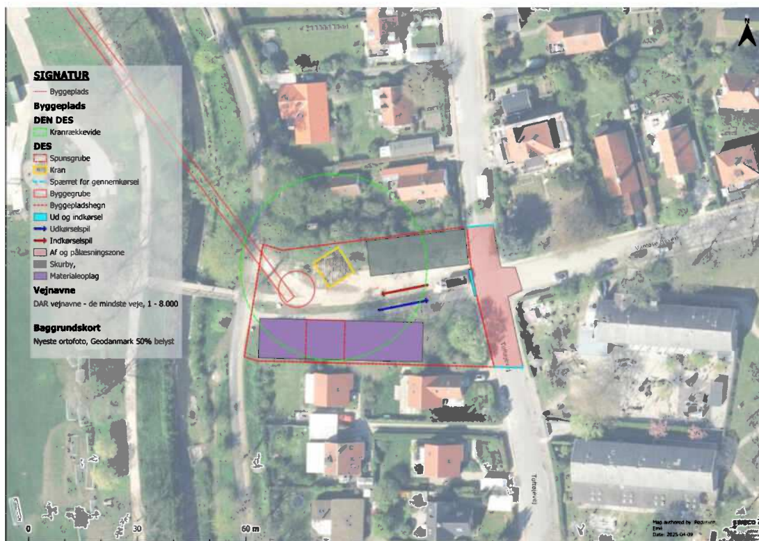
Figur 4-13 Indretningen af byggepladsen ved DES.
