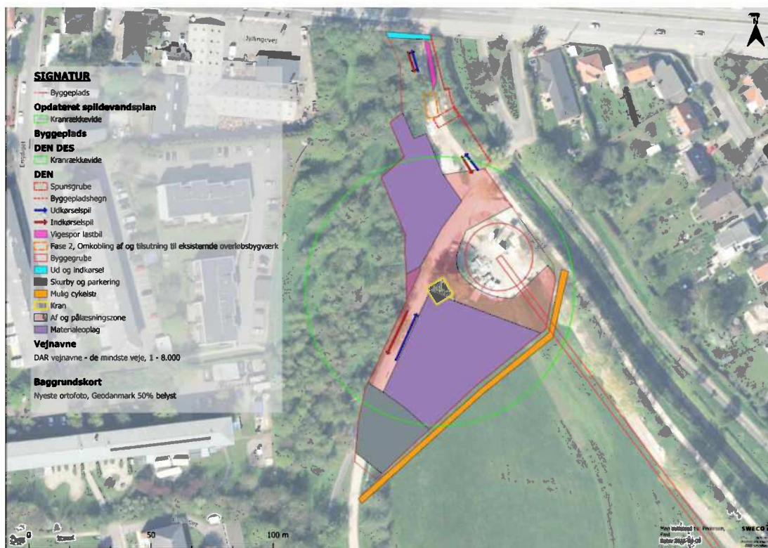
Figur 19-7 Byggepladsindretning ved DEN.
