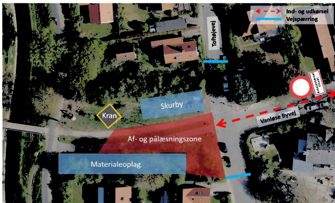
Figur 10-33 Vejlukning på Toftøjevej.
