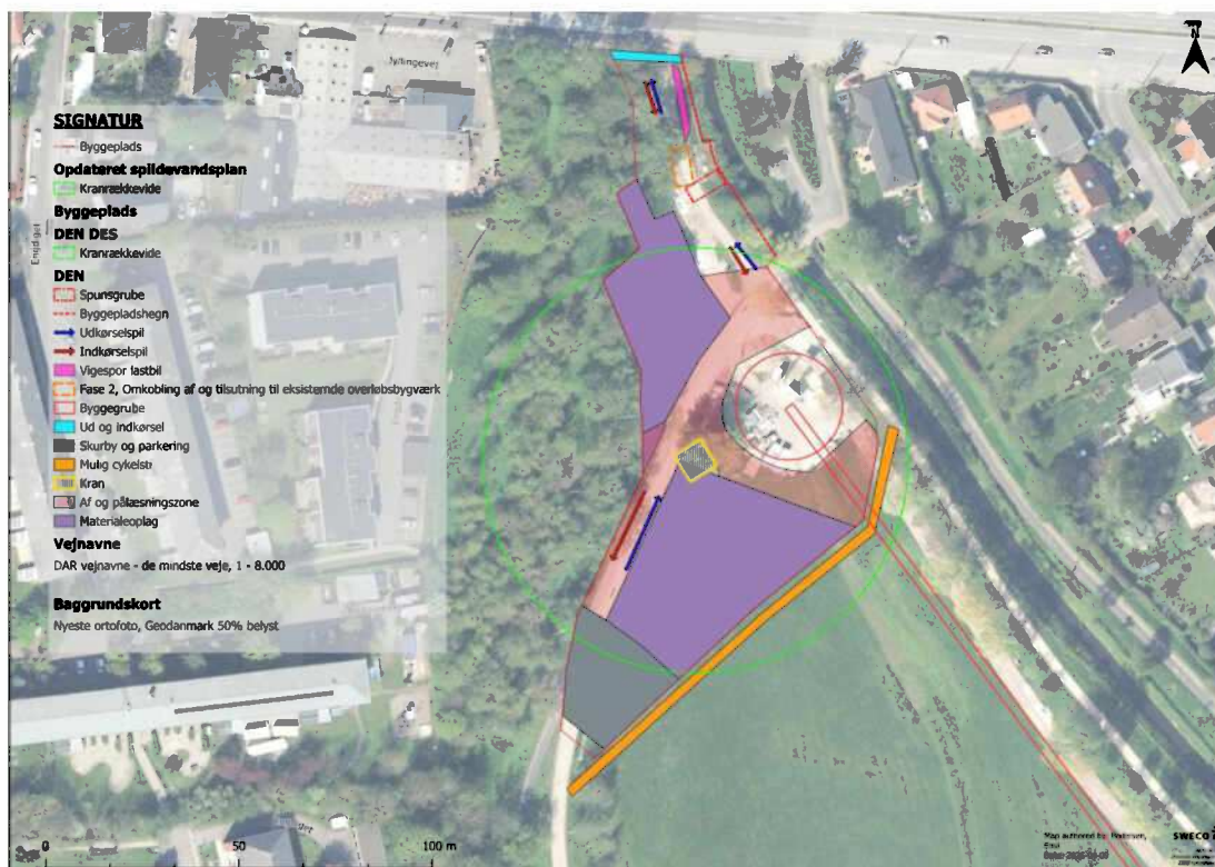
Figur 4-12 Indretningen af byggepladsen ved etablering af UH12 bassin og pumpestation.
