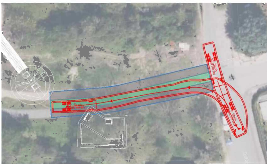
Figur 7-24 Service- og adgangsvej til UH11 i driftsfasen. Grøn markerer udbredelsen af græsarmeringssten. Rød er kørekurven for servicebilen. Hvid viser kranens krøjeområde.
