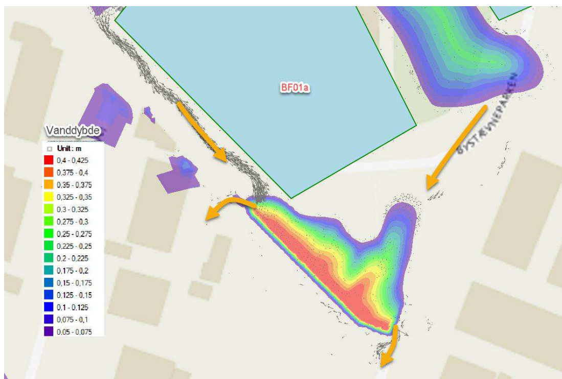
Figur 14: Udklip af simulering for BF01 område med fremtidig magasineringsvolumen.
