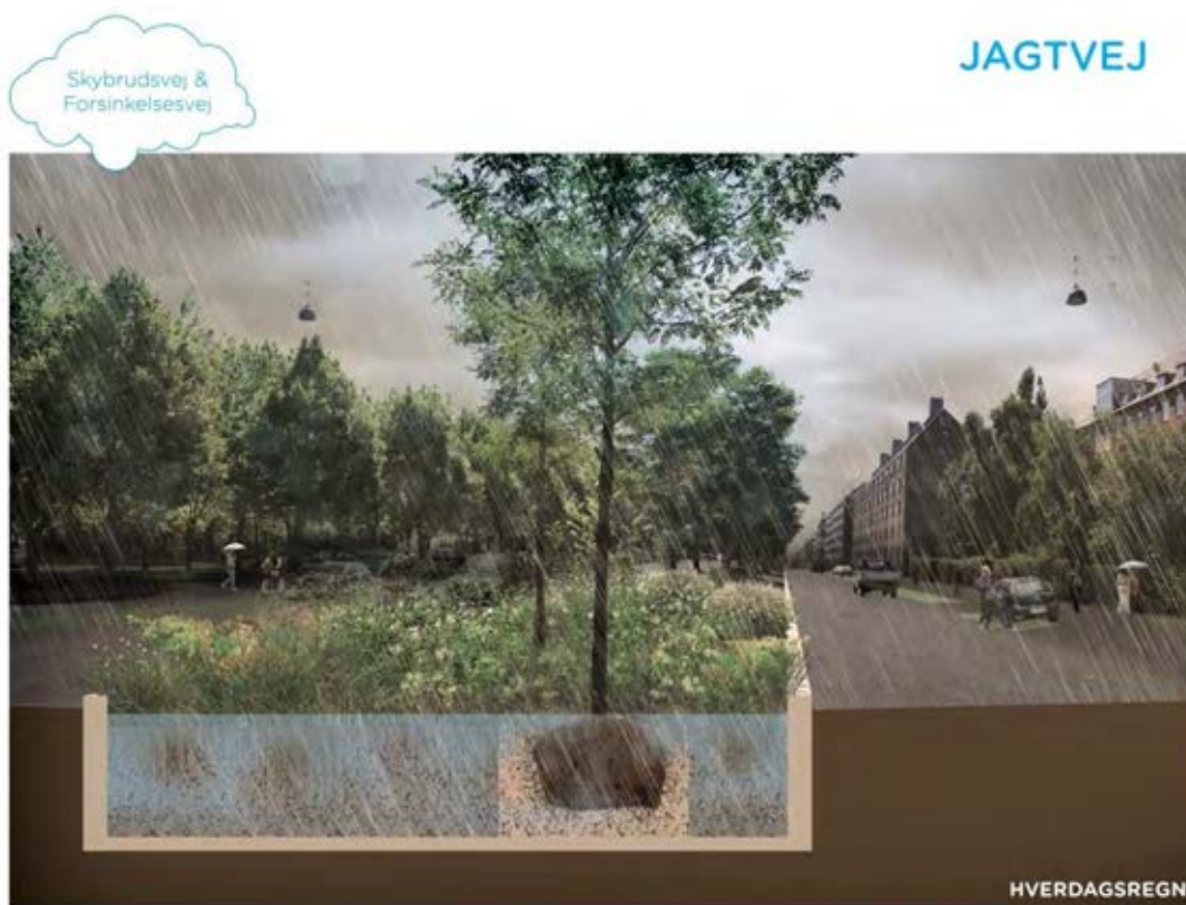
Figur 18 Skybrudsvej med grønne render og forsinkelsesvolumen til regnvand fra tage og fortove, – eksempel fra Jagtvej. Se bilag 0.3-212
