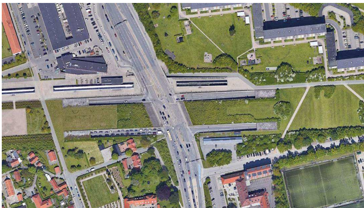
Figur 7-4 Tårnbyoverdækningen. Sideramper tilslutter til Englandsvej. Bemærk udbredelse af svingbaner Nord og Syd for tunnelen for at sikre en effektiv trafikafvikling (Google Earth).
