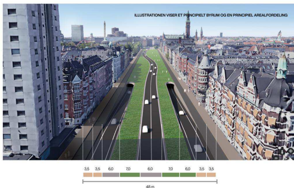
Figur 4-6 Princip med tunnel under Den Grønne Boulevard, hvor hovedtunnelen føres op til terræn ved Langebro. Trafikken over Den Grønne Boulevard afvikles i ydersiderne som i rambløsningen. Illustrationen er principiel og der er eksempelvis ikke indtegnet vejareal til tværgående veje.
