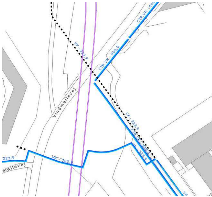
Billede 13: Området omkring skakten v. Vindmøllevej. Signaturbeskrivelse: Lilla M5// Mørkeblå hhv. HOFOR Fjernvarme og CTR Fjernvarme
