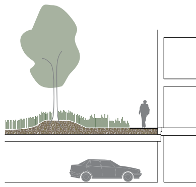
Principskitse for vækstlag over p-kælder i gårdrum.
