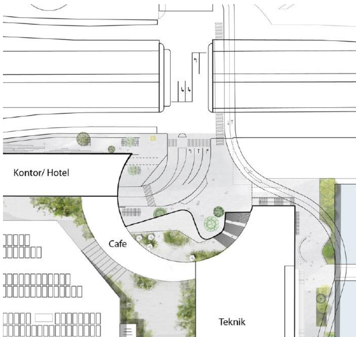
Figur 11: Illustration af, hvordan runddelen ved Fisketorvets hovedindgang bliver omlagt.
