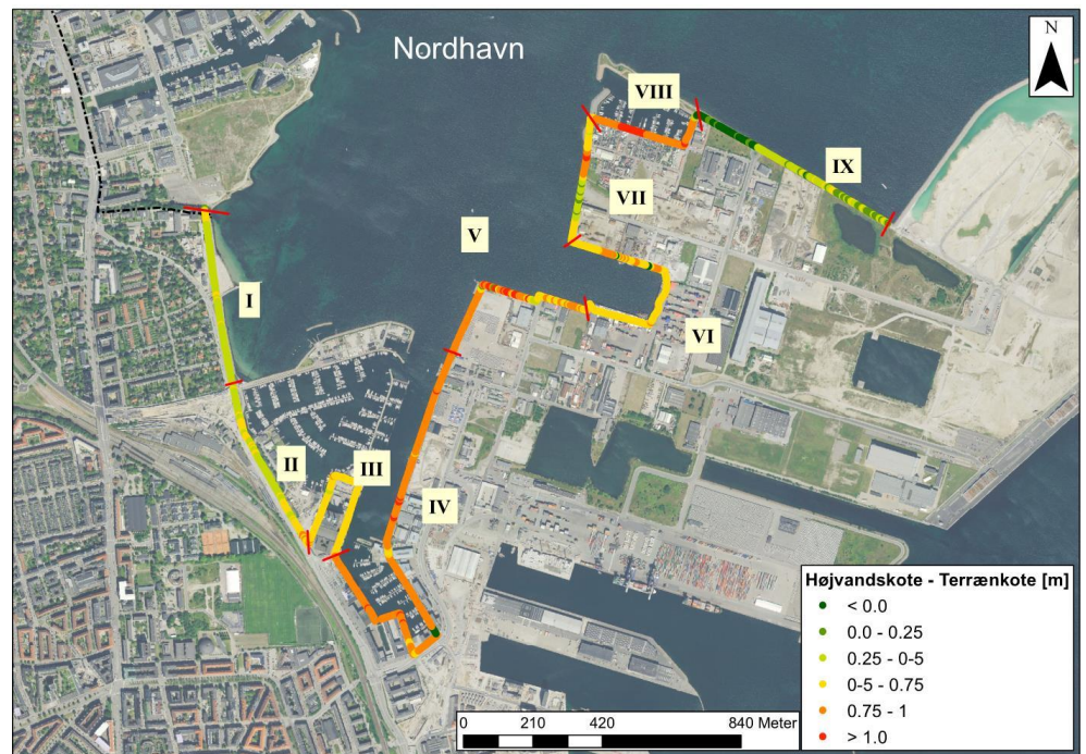
Figur 7-2 Kort for Nordhavn med forskellen mellem dimensionsgivende højvandskoter (2,7 m) og eksisterende terrænkoter. Der er her forudsat en stigning i havvandsstand på 100 cm i perioden 1990-2100. Stiger havet 87 cm skal alle højder og koter således reduceres med 13 cm.
