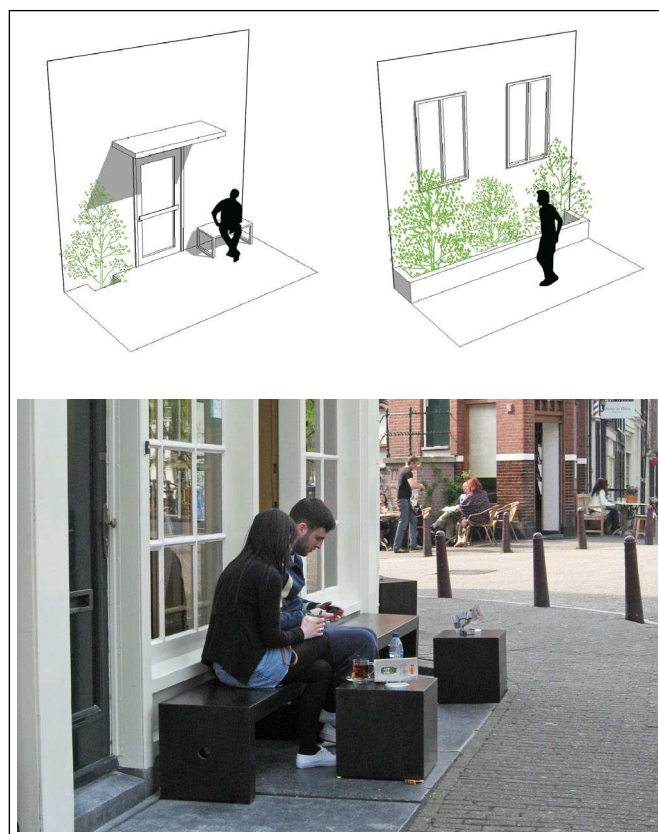
Fig. 8.6.b: Smal kantzone. Fotoet viser et eksempel på en smal kantzone med belægningsskift og opholdsmulighed. Skitserne viser eksempel på indretning af smalle kantzoner. Skitsen til venstre viser et indgangsparti indrettet med opholdsmulighed og beplantning. Skitsen til højre viser brug af beplantning i en hævet kantzone for at skabe en privat zone mellem bolig i stueetagen og fortov.
