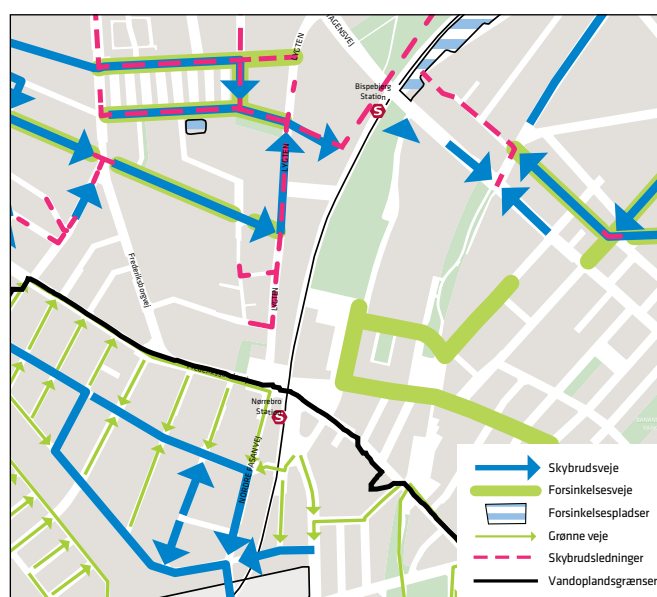
Det hydrauliske oversigtskort, der viser vandets vej.
